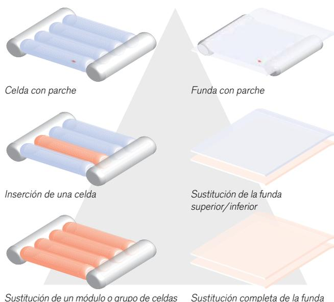
Sustitución de un módulo o grupo de celdas    Sustitución completa de la funda
