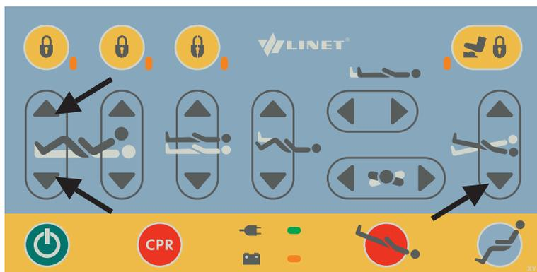
Fig. Desactivación del acumulador (panel de control del sanitario)
